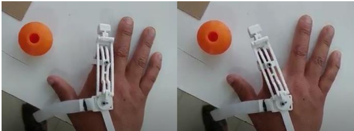
Figura 40: Foto de paciente 2 haciendo uso de prototipo realizando aducción y abducción. Fuente: Elaboración propia.
