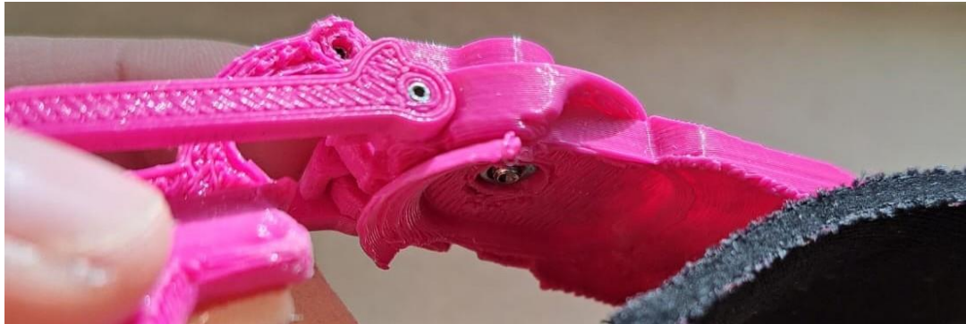
Figura 26: Foto de cavidad para nudillo de la prótesis. Fuente: Elaboración propia.
