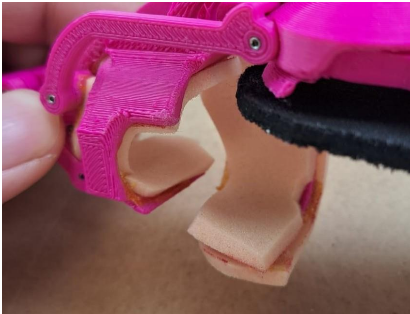
Figura 25: Foto de modelo final de prótesis mostrando gatillo acondicionado. Fuente: Elaboración propia.
