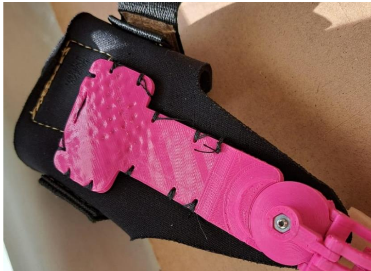
Figura 27: Foto de prótesis cosida a interfaz de neopreno. Fuente: Elaboración propia.
