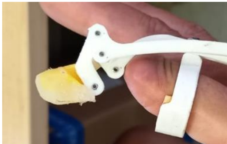
Figura 20: Foto de prototipo con falange distal con pulpejo de silicona. Fuente: Elaboración propia.
